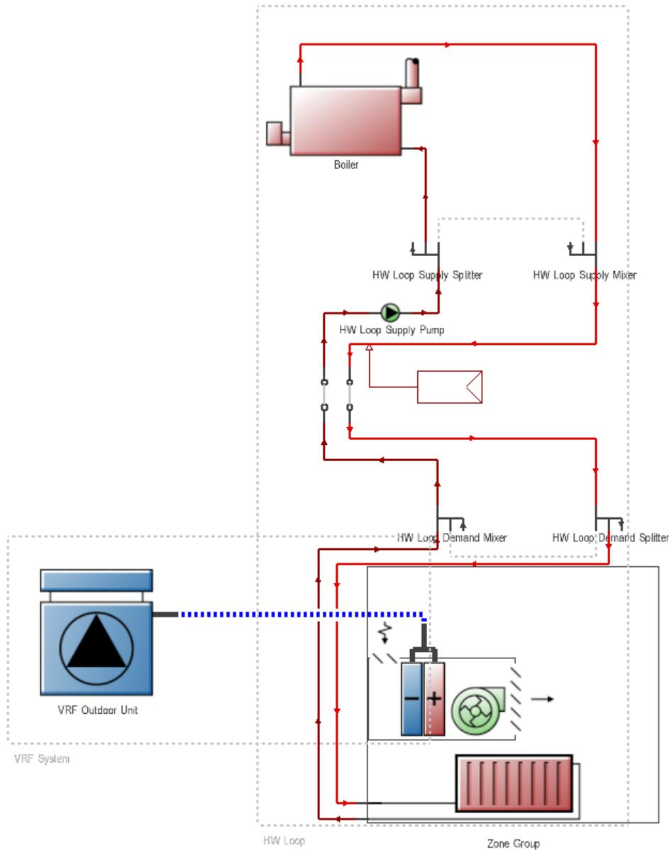
**Fig. 5. Schematic of VRF system.**
